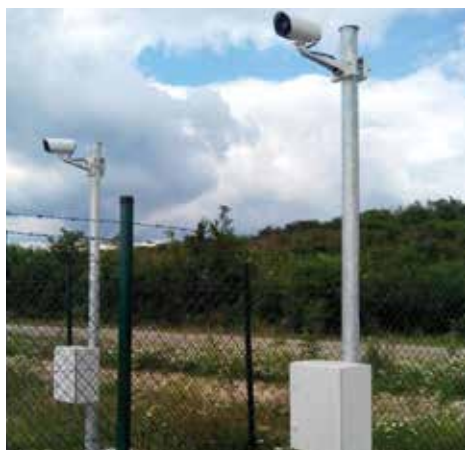
Тепловизионные камеры не требуют дополнительного освещения и работают с одинаковой точностью днем и ночью.
