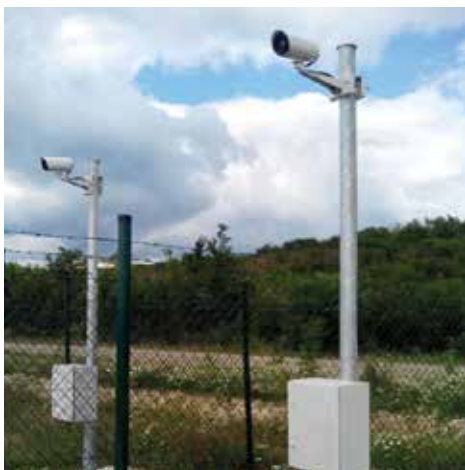
열화상 카메라는 조명시설이 전혀 필요하지 않으며 야간에도 주간과 동일한 수준의 정확도를 발휘합니다.
