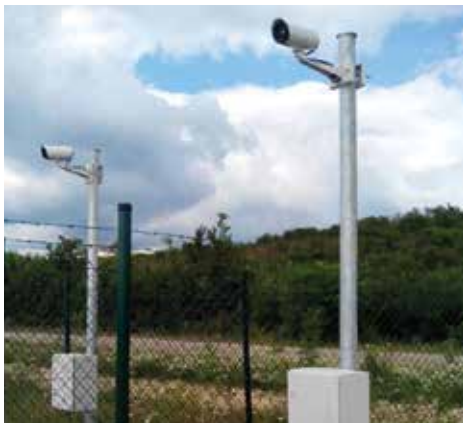
Le termocamere non richiedono alcuna fonte di illuminazione e funzionano con la stessa precisione di giorno e di notte.
