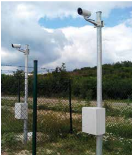
热像仪无需任何照明设备，而且可以同等精确度日夜运行。
