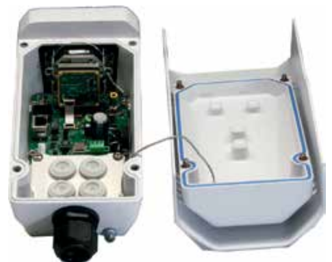
Die FC-Serie S wurde speziell für den Einsatz im Außenbereich entwickelt und ist mit einem speziellen Schutzschaltkreis ausgestattet, der nur das zu übermittelnde Signal durchlässt.
