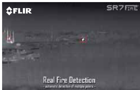
Mit dem Modell FC-309 kann das System eine durch Feuer überhitzte Fläche von 1 m 2 aus einer Entfernung von 2.500 Metern zuverlässig erkennen.
