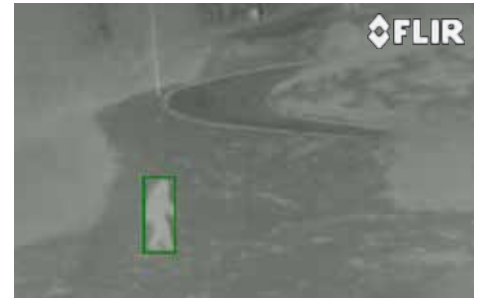
SR Wärmebildkameras von FLIR benötigen zur Erkennung von unbefugten Personen überhaupt kein Licht und arbeiten bei jedem Wetter.
