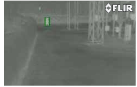
Die bei der Trafostation von Lyse Energy installierten FLIR Wärmebildkameras der SR-Serie können Ziele von der Größe eines Menschen aus mehreren hundert Meter Entfernung erkennen.
