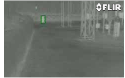
Lyse Energy变电所安装的FLIR SR系列红外热像仪可用于探测几百米之外的人形目标物。
