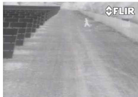
Срабатывание микроволнового извещателя является триггером для поворотного механизма — тепловизионная камера FLIR PT-313 автоматически наводится на нужный участок периметра, позволяя определить источник сигнала.
