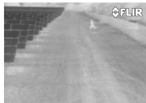
マイクロ波を利用したアラームシステムが作動すると、対象に最も近い場所に設置されたFLIR PT-313サーモグラフィが自動的にその方向を向き、状況を確認する。
