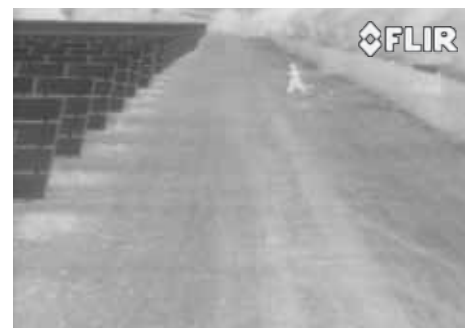
Wenn das Mikrowellen-System zur Erkennung unbefugter Personen ausgelöst wird, richtet sich die nächstgelegene FLIR PT-313 Wärmebildkamera zur Verifizierung automatisch auf die Position, wo der Alarm ausgelöst wurde.
