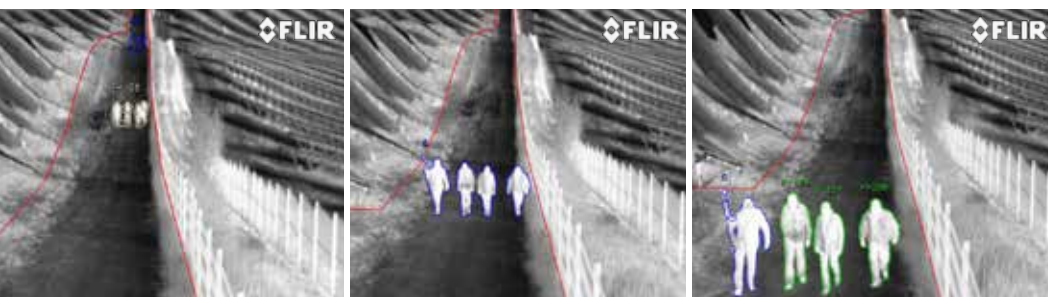
19mmレンズ、視野角24°のFLIR SR-324サーマルカメラで撮影した熱画像。左から、それぞれ約110m、40m、10m離れて撮影している。
