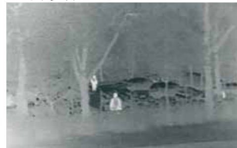
赤外線サーマルカメラFLIR SRシリーズで撮影した画像はコ ントラストが高いため、侵入者がはっきりと映っている。
