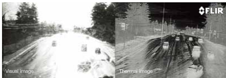
赤外線サーマルカメラは日光や車のライトの照り返しを見通すことができるため信号管理の効率が向上する
