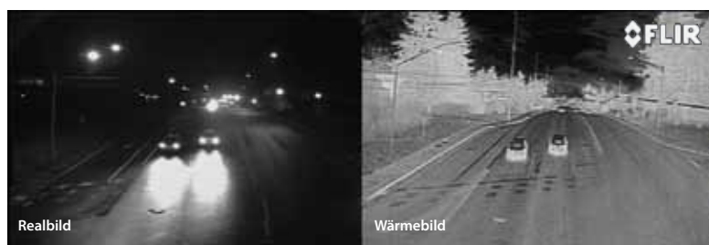
Wärmebildkameras sehen bei völliger Dunkelheit und zeigen detailreichere Szenen.
