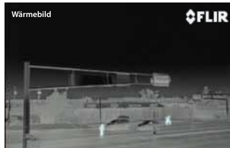
Wärmebildkameras sehen bei Dunkelheit Autos an der Haltelinie und Fußgänger an der Kreuzung.
