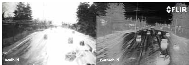
Wärmebildkameras sehen durch grelles Licht sowie bei Gegenlicht und verbessern damit die Signalsteuerung.
