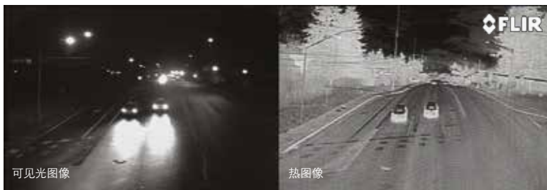
红外热像仪能在完全漆黑的环境下进行观测，并展现更多的场景细节。
