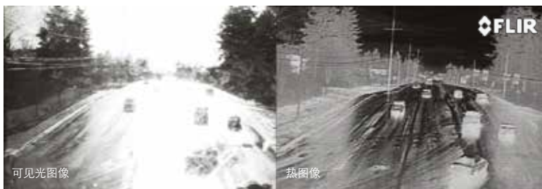
红外热像仪能透过眩光和逆光，提高信号控制。
