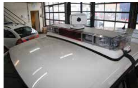
De FLIR PathFindIR kan door zijn compacte vormgeving, lichte gewicht en lage energieverbruik op simpele wijze in de elektrische installatie van politiewagens worden geïntegreerd.
