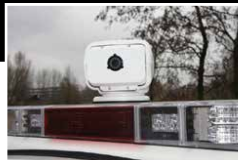
De FLIR PathFindIR warmtebeeldcamera is op een draai- en kantelbaar zoeklichtplatform gemonteerd.
