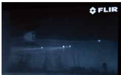
この2つの赤外線画像は川岸の葦の間に身を潜めている放火犯を示している。暗闇と葦にまぎれているため人間の眼には見えないが、FLIR PathFindIRの赤外線画像にははっきりと映っている。
