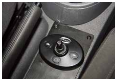
パン/チルトのプラットフォームはギアとブレーキの横に搭載
