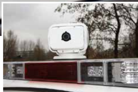
赤外線カメラFLIR PathFindIRはサーチライト用パンチルト台に設置されている
