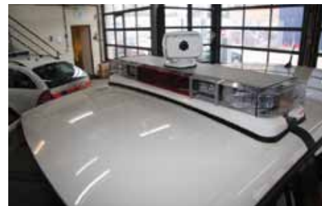
Die FLIR PathFindIR ist einfach in das elektrische System der Streifenfahrzeuge zu integrieren, denn sie ist kompakt, leicht und verbraucht nur wenig Strom.
