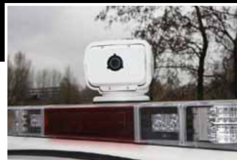
Die FLIR PathFindIR Wärmebildkamera wird auf die schwenk- und neigbare Plattform des Suchscheinwerfers montiert.
