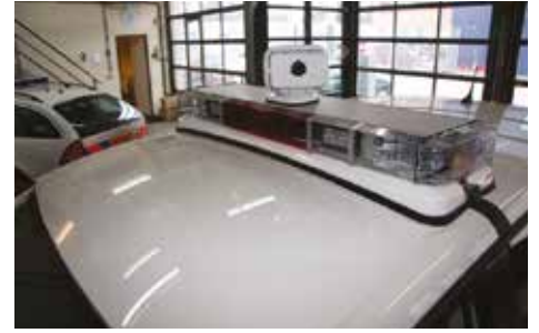
FLIR PathFindIR红外热像仪紧凑、轻便、能耗小，便于整合在巡逻警车的电气系统上。
