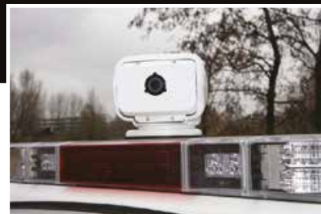
FLIR PathFindIR红外热像仪安装在探照灯方位/俯仰云台上。
