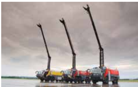
Зона досягаемости гидрофицированной стрелы Stinger равна 16,5 метра (в высоту).
