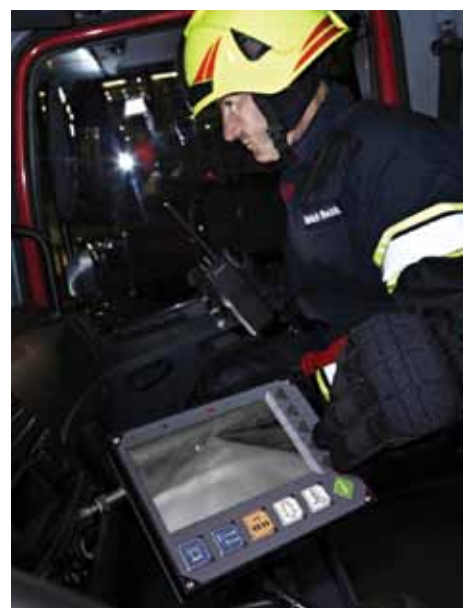
Тепловые изображения, получаемые с камеры FLIR PathFindIR, выводятся на многофункциональный экран в кабине машины.
