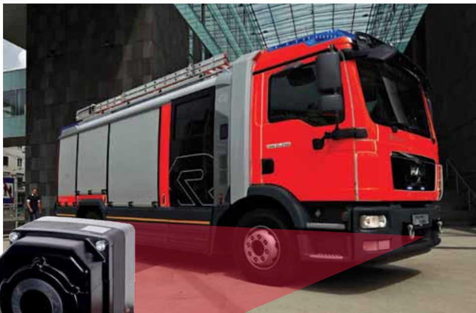
Эта новая пожарная машина серии AT производства Rosenbauer оснащена тепловизионной камерой FLIR PathFindIR, которая устанавливается на бампере, чтобы пожарные могли видеть в условиях задымленности, что особенно важно при пожарах в тоннелях.
