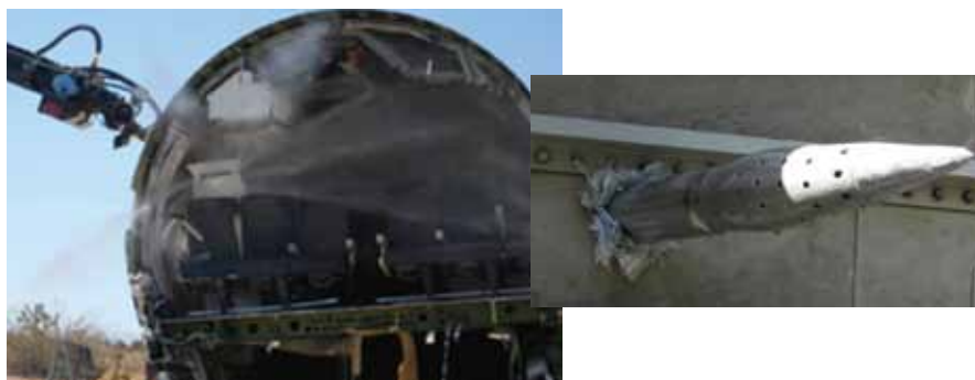
Данное испытание показало, что пробивной инструмент Stinger может пробить обшивку самолета с любого места. Юнгмайр: «И это делает оборудование Stinger поистине уникальным».
