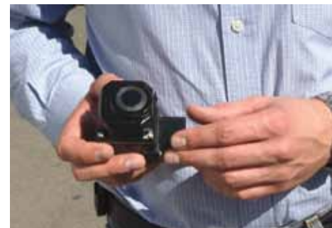
La FLIR PathFindIR è una macchina molto compatta e robusta in grado di proteggere le sue parti vitali da acqua e umidità, una delle caratteristiche che ne ha determinato la scelta per i veicoli della Rosenbauer.
