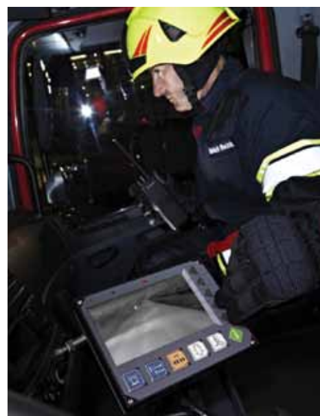
Le termografie eseguite dalla FLIR PathFindIR vengono visualizzate sullo schermo multifunzione nella cabina del veicolo.
