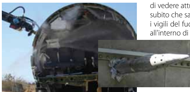
Questo test illustra come la punta di perforazione dello Stinger sia in grado di penetrare nello scafo di un aereo da qualsiasi direzione possibile. Jungmair: "Questa caratteristica rende lo Stinger davvero unico".
