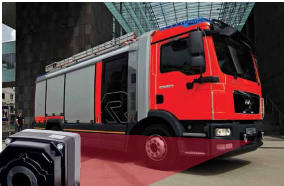
Questo nuovo veicolo antincendio Rosenbauer della serie AT è dotato di una termocamera ad infrarossi FLIR PathFindIR installata sul paraurti con lo scopo di aiutare i vigili del fuoco a vedere attraverso il fumo, un vantaggio prezioso ad esempio in incendi all'interno di gallerie.
