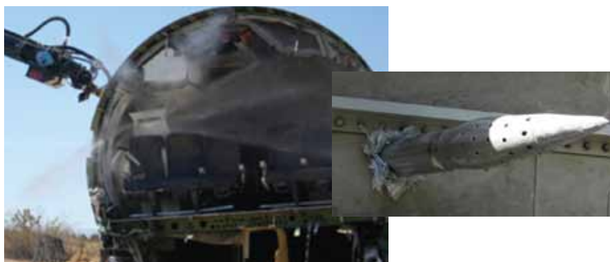
Cet essai montre que le Stinger peut perforer le fuselage d'un avion dans n'importe quelle direction. "Cela fait du Stinger un outil vraiment unique", précise M. Jungmaier.
