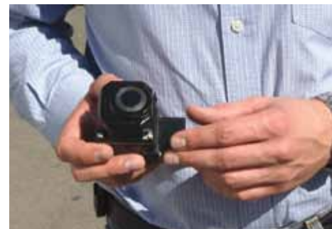
La FLIR PathFindIR est très compacte, et sa conception robuste protège bien ses organes contre l'humidité et l'eau. C'est une des raisons importantes pour lesquelles Rosenbauer a choisi ce modèle de caméra thermique.
