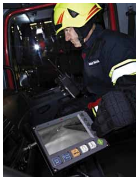
Les images thermiques de la FLIR PathFindIR sont affichées sur l'écran multifonction, dans l'habitacle du véhicule.
