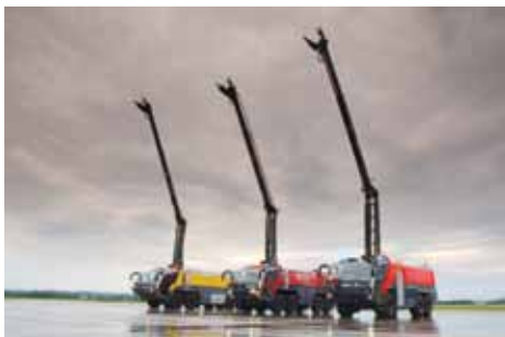
Le bras hydraulique du Stinger a une portée verticale de 16,5 m.
