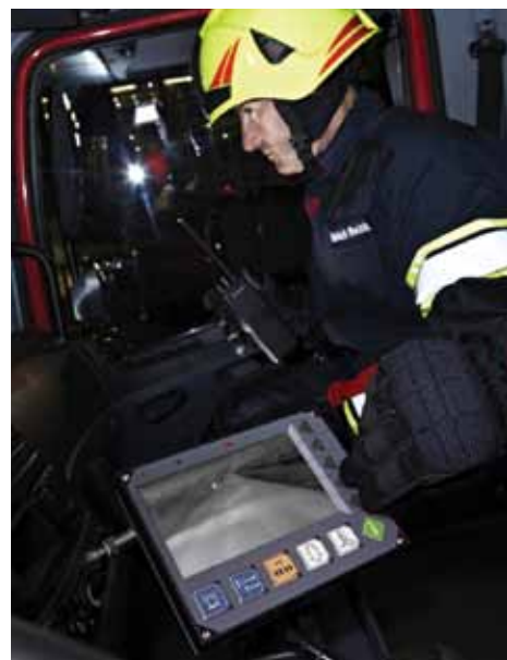
Las imágenes térmicas de la PathFindIR de FLIR se visualizan en una pantalla multifuncional situada en la cabina del vehículo.
