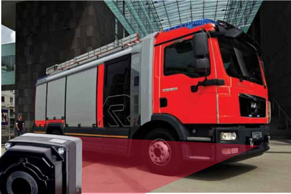
Este nuevo coche de bomberos de la serie AT de Rosenbauer está equipado con una cámara de imagen térmica PathFindIR de FLIR instalada en el parachoques para facilitar a los bomberos la visión a través del humo, algo que es especialmente útil cuando se producen incendios en los túneles.
