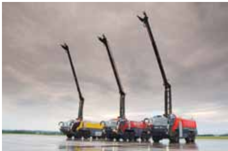
El brazo hidráulico de la Stinger tiene un alcance de 16,5 metros de altura.
