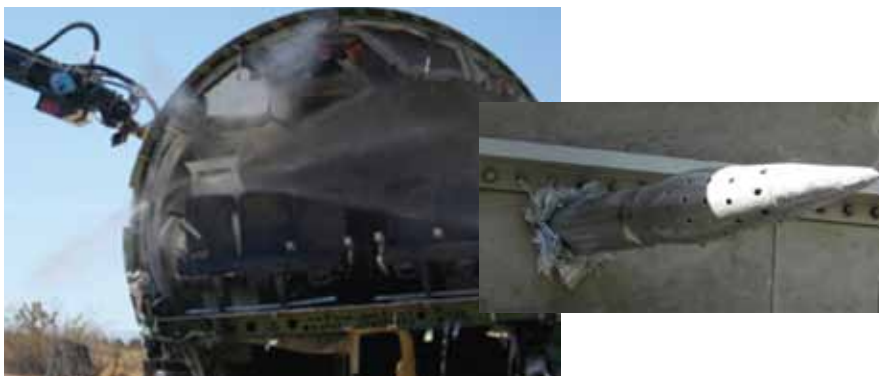
Con esta prueba se demuestra que el instrumento punzante de la Stinger puede perforar el casco de un avión desde cualquier dirección posible. Jungmair: «Esta posibilidad hace que la Stinger sea realmente única».
