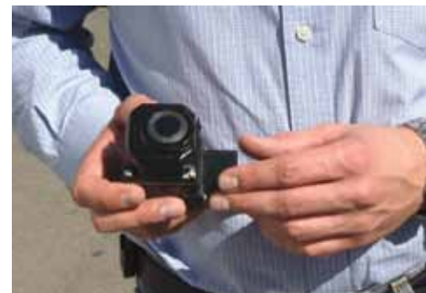
La PathFindIR de FLIR es muy compacta y su diseño robusto mantiene bien protegidos los elementos vitales de la humedad y el agua, una razón importante para que Rosenbauer eligiera esta cámara de imagen térmica.
