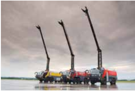
Der hydraulische Arm des Stinger kann eine Höhe von 16,5 m erreichen.
