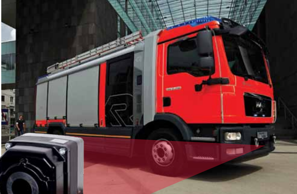
Dieses neue Löschfahrzeug der AT-Serie von Rosenbauer ist mit einer PathFindIR-Wärmebildkamera von FLIR ausgerüstet, die auf der Stoßstange montiert ist, um den Feuerwehrleuten zu helfen, durch Rauch hindurch zu sehen, was bei Tunnelbränden besonders nützlich ist.
