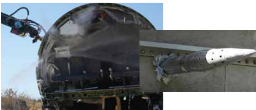
Dieser Test zeigt, dass der Dorn an der Stinger-Löschlanze eine Flugzeughülle aus jeder Richtung durchstoßen kann. Jungmair: "Das macht den Stinger wirklich einzigartig auf der Welt."
