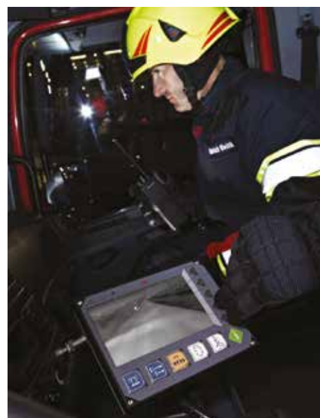
FLIR PathFindIR热图像显示在车辆驾驶室的多功能屏幕上。
