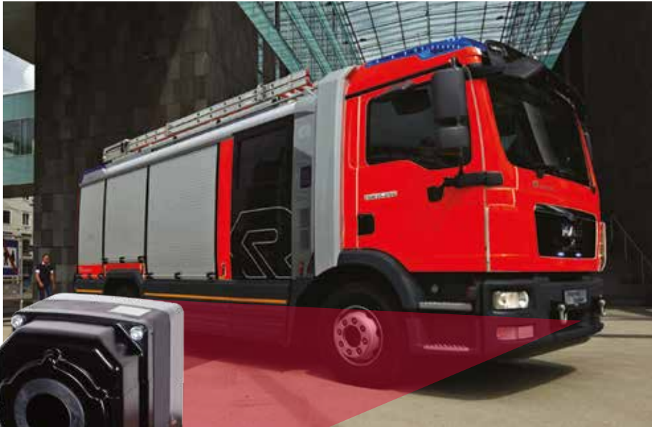
卢森堡生产的AT系列新款消防车在保险杠上安装有PathFindIR红外热像仪，能帮助消防队员透过烟雾看到清晰图像，十分适用于隧道救火。
