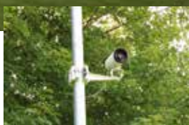
洪水危険エリアの監視をするフリーシステムズの赤外線カメラ。照明が不要で、長距離監視が可能であるため、離れた安全な場所から全エリアを監視できる。
