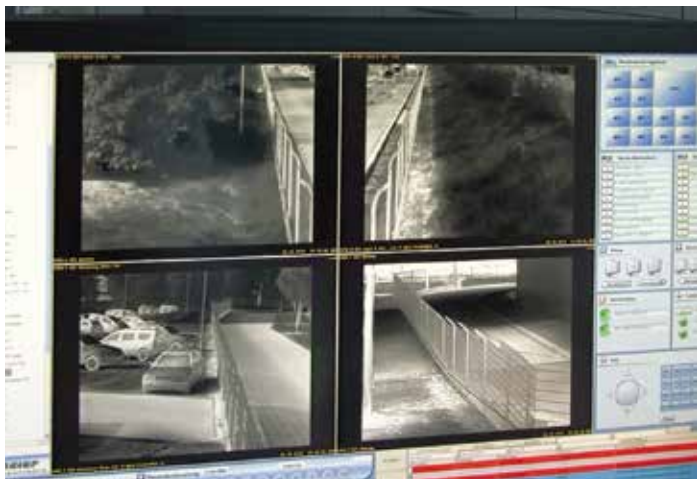
視覚解析ソフトは赤外線カメラと接続した場合に威力を発揮する 「侵入者は熱コントラストにより鮮明に映し出されます。」とKrüger氏
