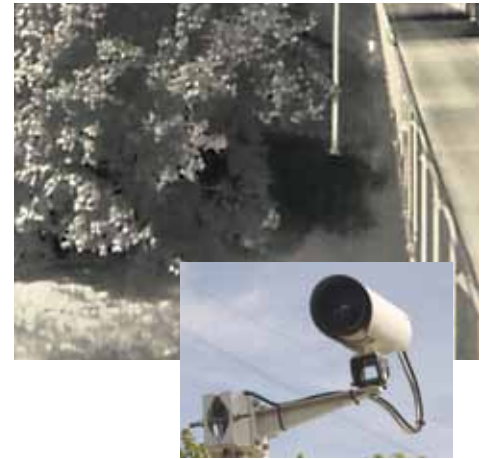
Les branches agitées par le vent provoquent de nombreuses fausses alertes à cet endroit. Par conséquent, M. Krüger a décidé de remplacer la caméra de CCTV par une caméra thermique. Depuis ce changement, il n'a plus enregistré une seule fausse alerte.
