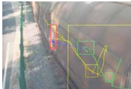
Les cadres rouges indiquent une alarme, ici injustifiée et provoquée par un graffiti sur le train en mouvement. L'image d'une caméra thermique n'aurait pas déclenché cette alarme.
