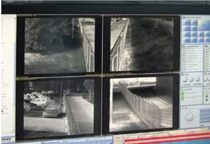
Le logiciel d'analyse vidéo est beaucoup plus efficace sur les images thermiques. "On distingue parfaitement les intrus grâce au contraste thermique", explique M. Krüger.
