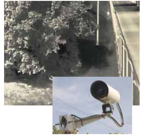
Sich im Wind bewegende Äste haben an diesem Standort viele Fehlalarme verursacht, daher entschied der Leiter des Kontrollzentrums, die Videoüberwachungskamera hier durch eine Wärmebildkamera zu ersetzen. Seitdem ist kein einziger falscher Alarm mehr aufgetreten.
