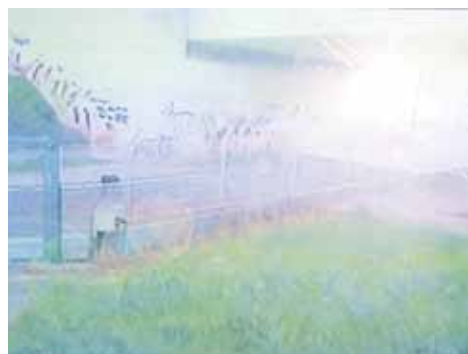
Von Spinnweben vor dem Objektiv reflektiertes Sonnenlicht blendet diese Videoüberwachungskamera vollständig.
