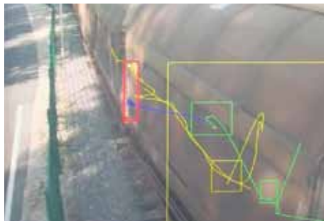
Die roten Bereiche zeigen einen Alarm an, in diesem Fall einen falschen Alarm, der von Graffiti auf der Seite des Zuges ausgelöst wurde. Bei einer Wärmebildkamera hätte dies keinen Alarm ausgelöst.
