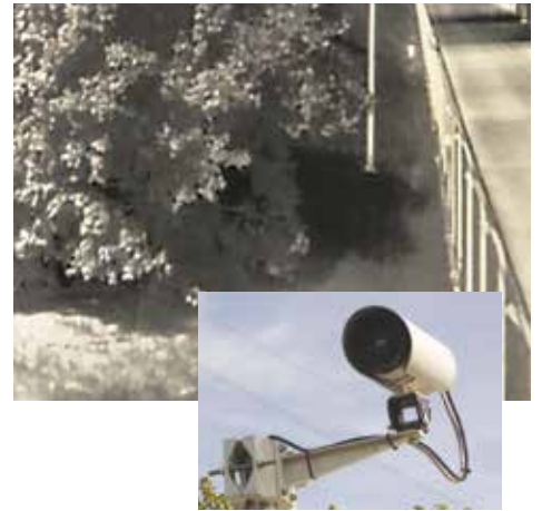
在这个位置，风中摇晃的树枝造成许多误报警，所以Krüger决定用红外热像仪代替闭路电视摄像机。自此再也没有发生过误报警。
