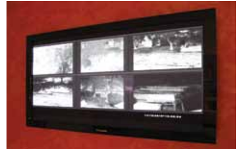
Die Wärmebilder der sechs FLIR SR-313 Wärmebildkameras können auf jedem der sechs Bildschirme im Haus angezeigt werden.
