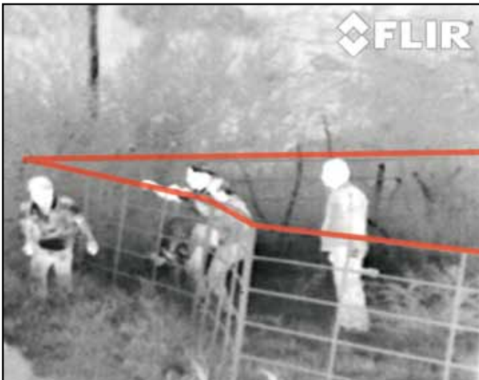
Die Software FLIR Sensors Manager beinhaltet ein hochmodernes Videoanalysemodul. Der Anwender kann virtuelle Stolperdrähte und andere Alarmauslöser platzieren. Wenn jemand den virtuellen Draht passiert, wird ein stiller Alarm abgesetzt.
