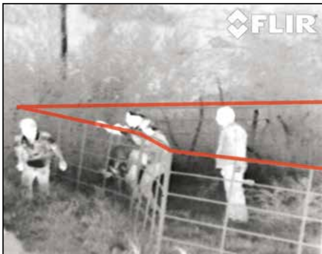
FLIR Sensor Manager Pro软件包含了一个先进的视频分析组件。户主可以放置虚拟绊网或其他触发器。如果有人穿过这条绊网，系统就会响起无声警报。
