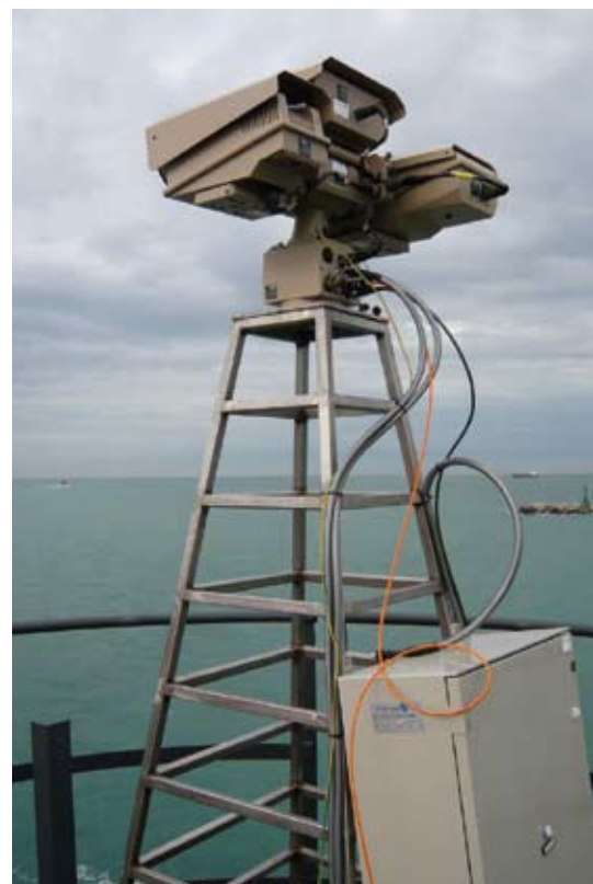
L'HRC-S MS controlla l'ingresso del Porto di Ravenna.
