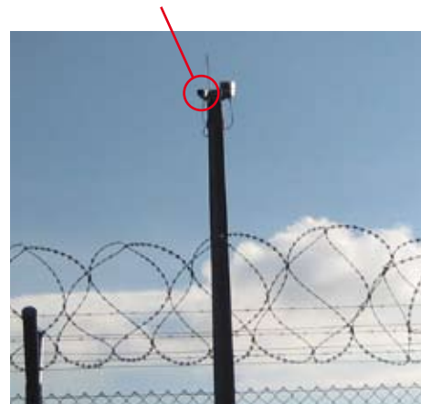
FLIR Systems SR-100はCCTVカメラとともにパンティルト雲台に搭載され、滑走路沿いに立っている鉄柱に設置されています。
