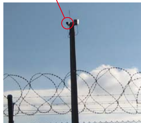
Die SR-100 von FLIR Systems ist gemeinsam mit einer herkömmlichen CCTV-Kamera auf einem Schwenk-/Neigekopf montiert. Diese Systeme wurden auf Masten rund um die Start- und Landebahnen installiert.
