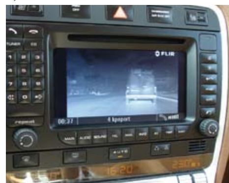
Тепловизионные изображения, генерируемые PathFindIR могут быть отображены на любом мультимедийном ЖК дисплее, поддерживающем композитный видеосигнал. В этом случае на ЖК дисплее, интегрированном в приборную панель Porsche
