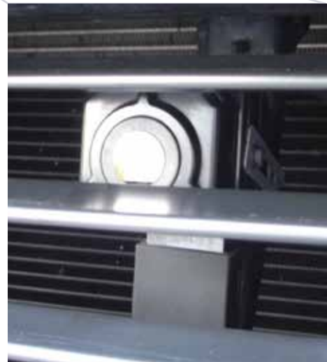
安装于保时捷卡宴散热器格栅后的FLIR Systems PathFindIR红外热像仪
