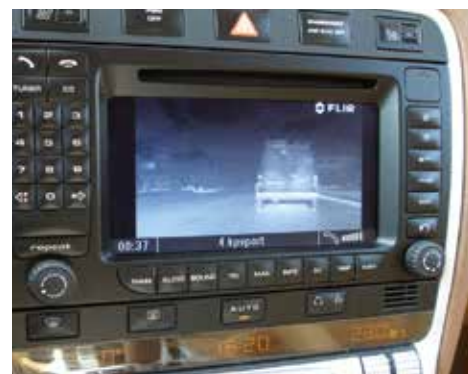
PathFindIR红外热像仪生成的热图像可显示在任何一个接收复合视频的多功能LCD显示屏上。本案例中, 热图像显示在保时捷仪表盘上的LCD显示屏上。
