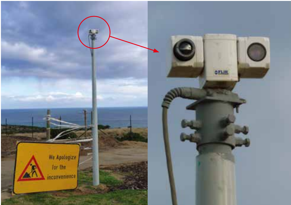
Oubaaiを監視しているフリーアシストシステムの赤外線カメラ PTZ-50 MS
