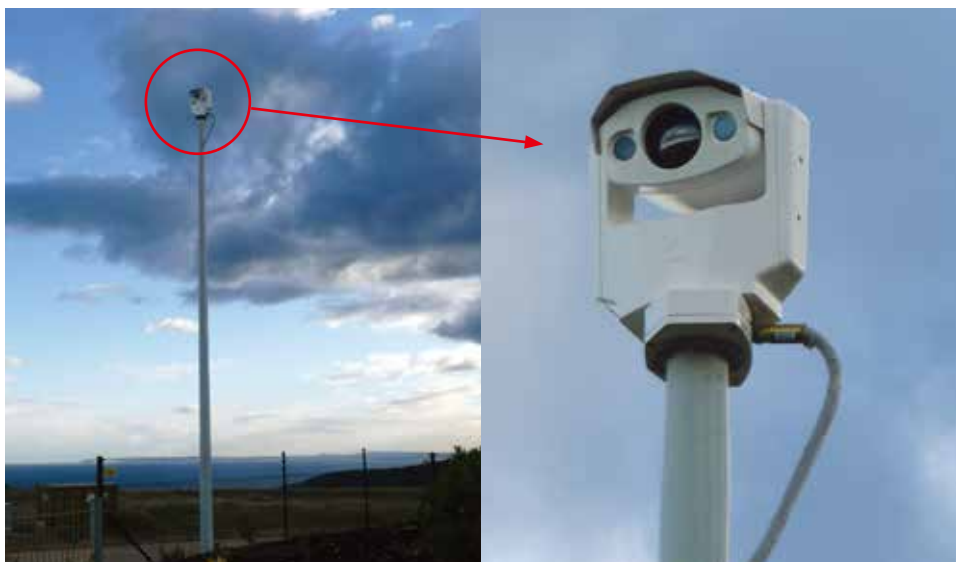
フリーシステムズのPTZ-35x140 MSは赤外線カメラ2台と低照度CCDカメラ1台を搭載しています。Oubaaiエステートの広範囲を監視します。
