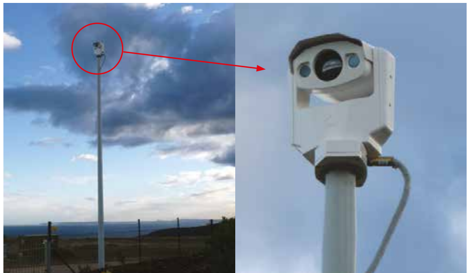
FLIR系统PTZ-35x140 MS。它包含2台热像仪和一台白光/微光摄像机，俯瞰着Oubaai庄园的大部分区域。
