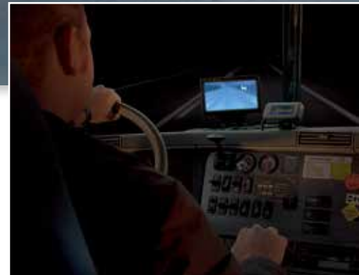
PathFindIRの画像を映し出しているモニターはダッシュボード上に簡単に置くことができます。すぐにサイドミラーやバックミラーと同様ドライバーにとって自然なチェックポイントになります。
