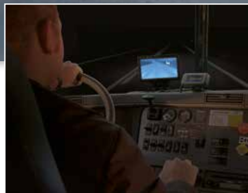
显示PathFindIR产生的热图像的显示器可轻松呈现于仪表盘上。它可快速成为驾驶员的自然查看点，与汽车的侧视镜和后视镜类似。
