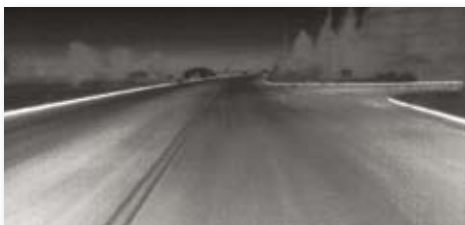
Даже в абсолютной темноте дальность обнаружения при использовании системы PathFindIR в 5 раз выше, чем при свете фар.
