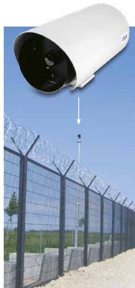
沿11公里长的安全护栏安装的22台FLIR Systems SR-35红外热像仪
