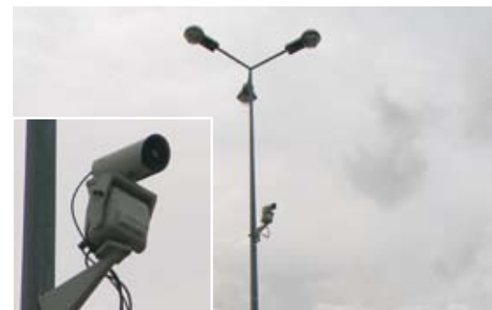
Una de las cámaras SR-50 de FLIR Systems en el puerto de Calais
