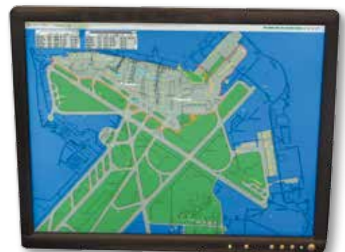
立入制限区域(CSRA)を出入りするものはすべて陸上レーダーが追跡します。CSRAは赤いラインで示されています。
